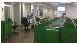
▲ Az automata könyvvisszavételhez tartozó futószalag tematikusan leválogatja a különböző raktárakba ▼ helyesr sorolandó könyveket.
