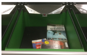
▲ Az automata könyvvisszavételhez tartozó futószalag tematikusan leválogatja a különböző raktárakba ▼ helyesr sorolandó könyveket.
